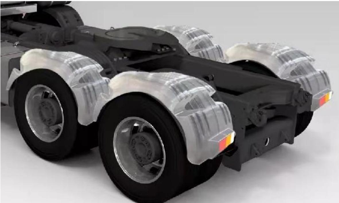
**6. Guardabarros de automóvil, tamaño: 1315x540x670 mm, impreso con impresora 3D de pellets, pellet PETG de 10 kg, 30 horas**
